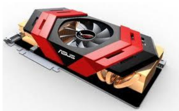
Rysunek 9 Karta grafiki z chłodzeniem aktywnym ( wentylator)
