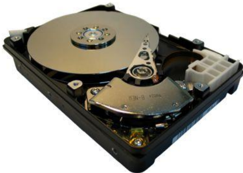
Rysunek 6 wnętrze dysku twardego. Widoczne talerze oraz pracująca głowica.
